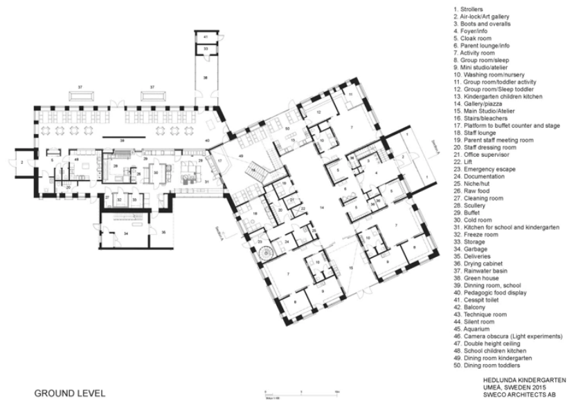
Figur 34. Förskolans huvudbyggnad är ett kubformat hus i två plan. Matsalen vetter mot öster. Barn och föräldrar kommer in i huset genom en gemensam, centralt placerad, entré som vetter mot sydost. Den rymliga och välkomnade entrén används för hämtning och lämning, men också för barnens utställningar och ansluter till kapprum för respektive förskoleavdelning. Personalen har en egen entré. Illustration: Sweco Architects
