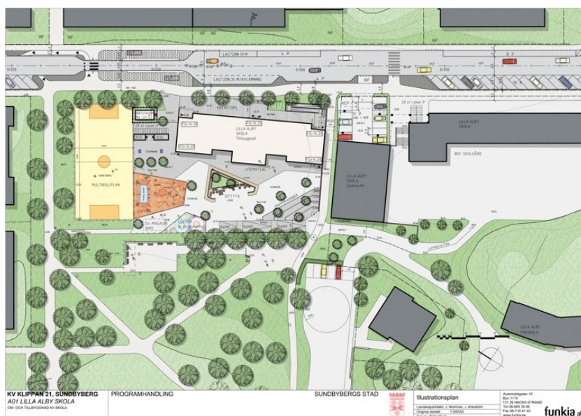
Figur 81. Illustrationsplan där den tillbyggda delen är ljus och den äldre mörk. Mellan den nya och gamla byggnaden ligger idrottshallen och fritidsverksamhet. Den nya skolgården innehåller multisportarena, och har ett underjordiskt magasin för uppsamling av dagvatten. Illustration: Funkia Landskapsarkitektur
