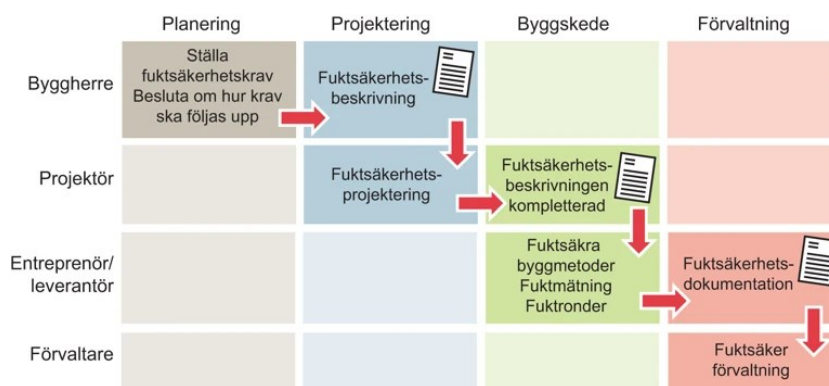
Figur 5. Illustrationen visar metod för systematisk fuktsäkerhet. Illustration efter idé från Sveriges byggindustrier. Illustration: Boverket / Altefur Development
