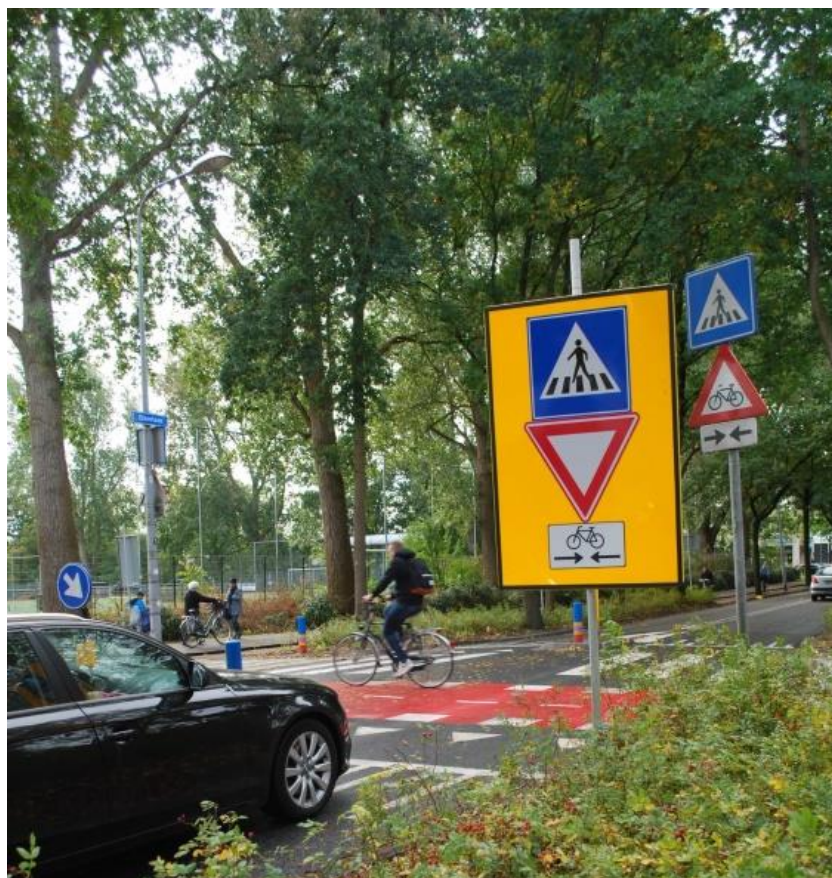
Test av ändrad prioritet i krosningen mellan bilväg och cykelbana. Foto: Boverket
