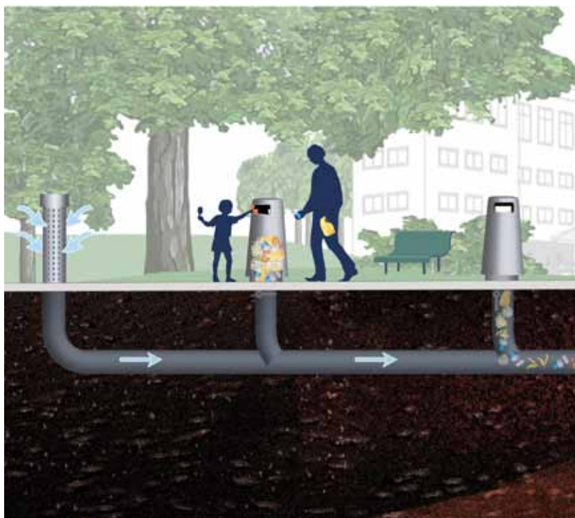
▲ Principskiss på stationär sopsug med papperskorgar på offentlig plats.
