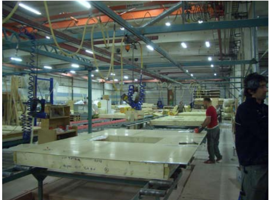
Figur 34 Tillverkning av väggelement i fabriken
