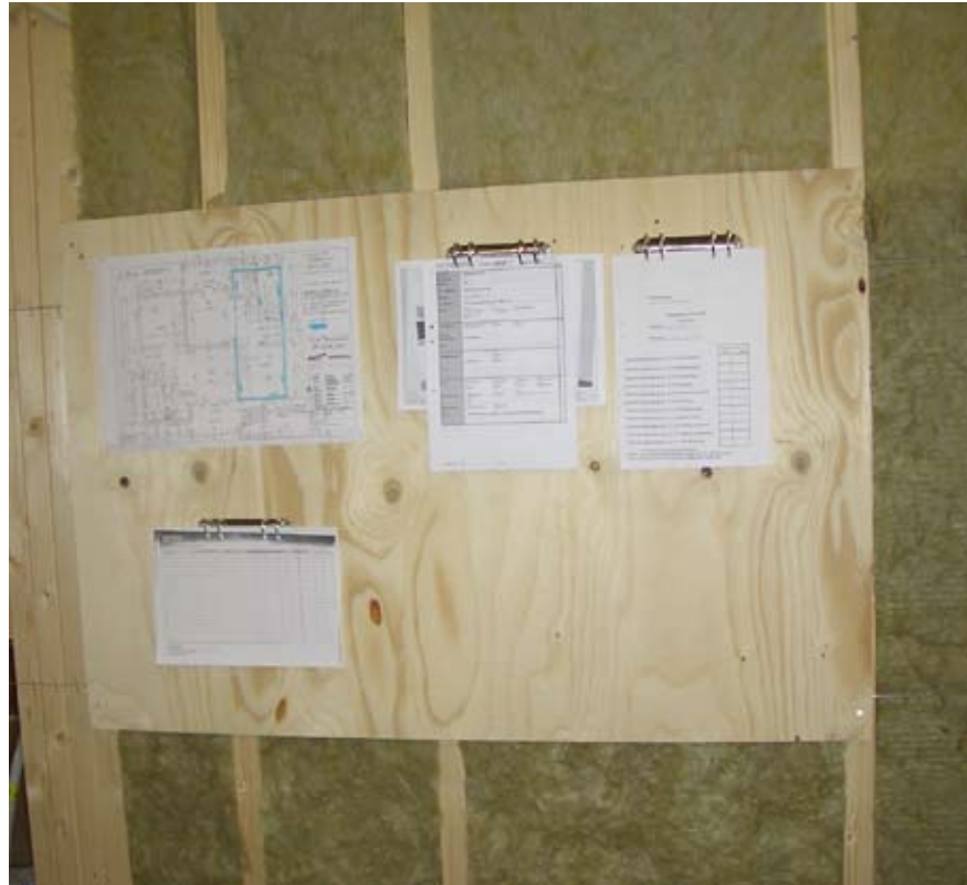
Figur 37 En tillverkningsorder fastsatt på volymelementet i fabriken
