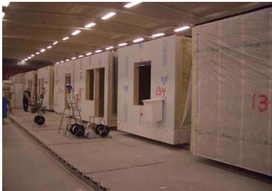
Figur 14 Volymelement tillverkas i fabriken
