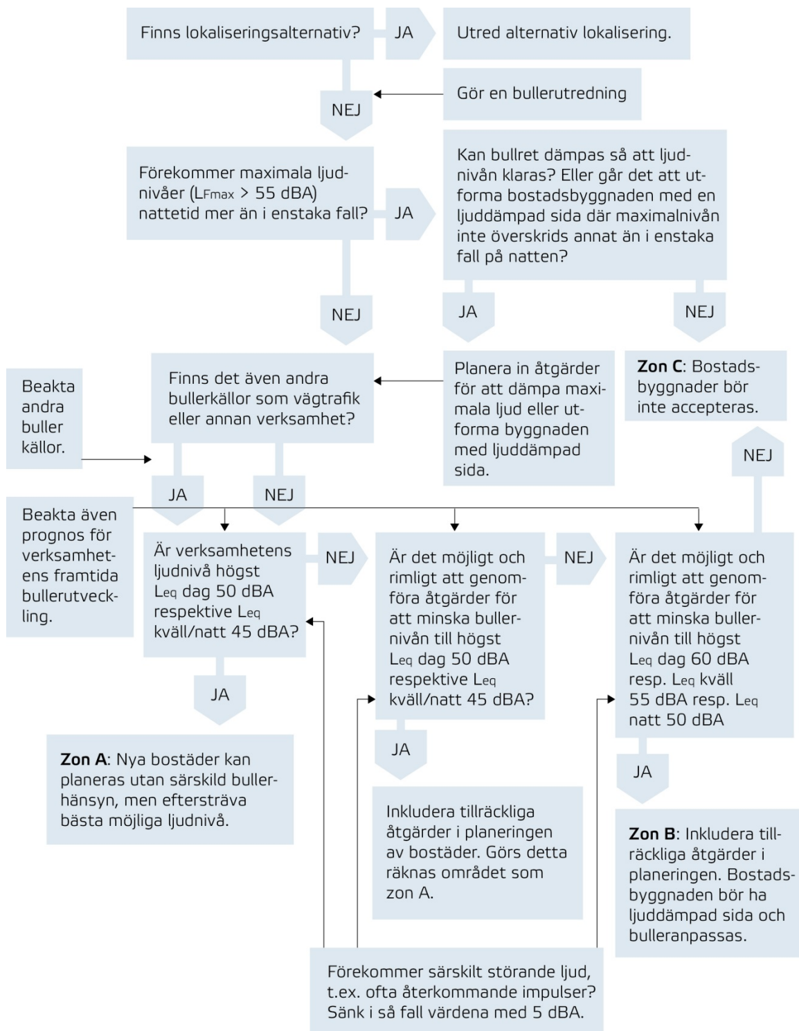
Figur 2. Flödesschema, arbetsgång vid planläggning av nya bostäder i bullerutsatta lägen.
