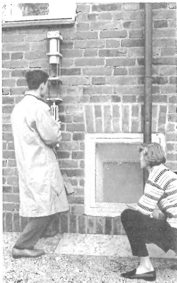
Fig. 41. Fotografering av fasadens solavskärmning med globoskop.
