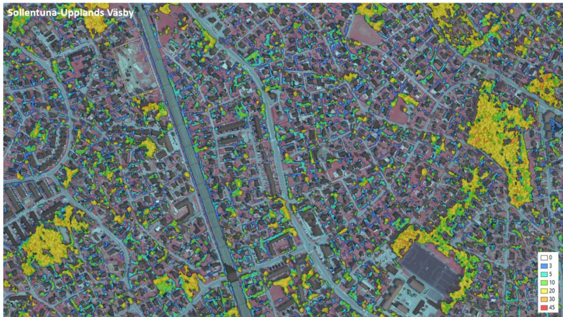
Figur 14. Från ytmodellerna i färg framställdes raster visande vegetation ovan mark. Resultatet ovan är klassat i olika intervall av höjdvärden där 3-5m är den lägsta klassen och 30-45m den högsta. Detta resultat framställdes utifrån en ytmodell framställd från flygfoton tagna efter lövsprickning.
