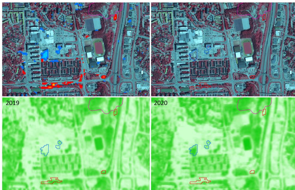
Figur 17. Justering av minsta karteringsenhet för att identifiera både positiva och negativa förändringar av NDVI. Mellan 2019 och 2020 sker både en förändring i positiv och negativ riktning inom ytorna. Vegetation tillkom inom blå ytor och vegetation försvann inom röda ytor.
