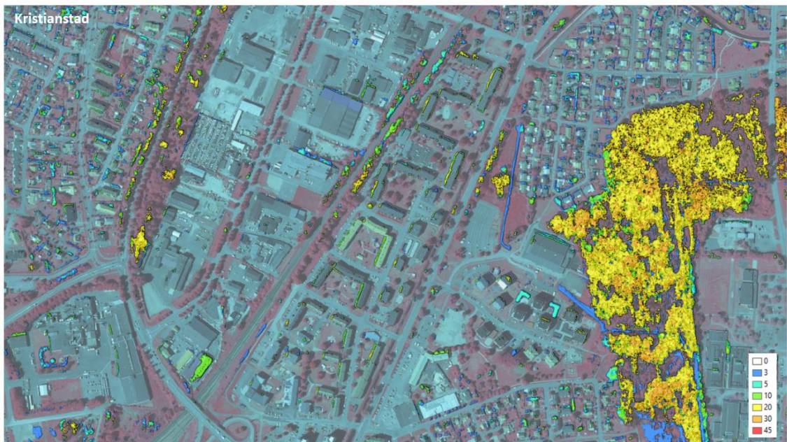
Figur 15. Från ytmodellerna i färg framställdes raster visande vegetation ovan mark. Resultatet ovan är klassat i olika intervall av höjdvärden där 3-5m är den lägsta klassen och 30-45m den högsta. Detta resultat framställdes utifrån en ytmodell framställd från flygfoton tagna innan lövsprickning, vilket resulterade i att alla träd inte kom med.
