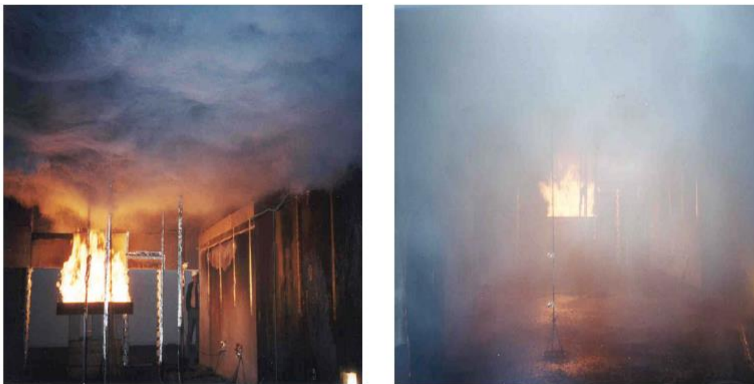
Figur 3 Illustration av sprinklerns påverkan på brandgaslagret 5 .
